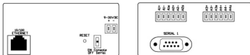
IOLAN SDS1 TA4D2 – 4 analoge Eingänge und 2 digitale E/A und 1 serieller RS-232/422/485-Port
