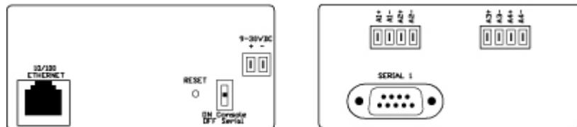
IOLAN SDS1 TT4 – 4 Thermoelement-/RTD-Sensoreingänge und 1 serieller RS-232/422/485-Port
