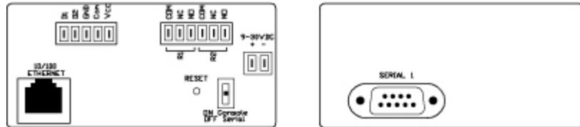
IOLAN SDS1 TA4 – 4 analoge Eingänge und 1 serieller RS-232/422/485-Port
